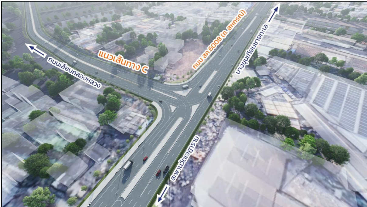
รูปที่ 18 รูปแบบทางแยกระหว่าง แนวเส้นทาง C กับ ทางหลวงชนบทสาย สค. 6008
