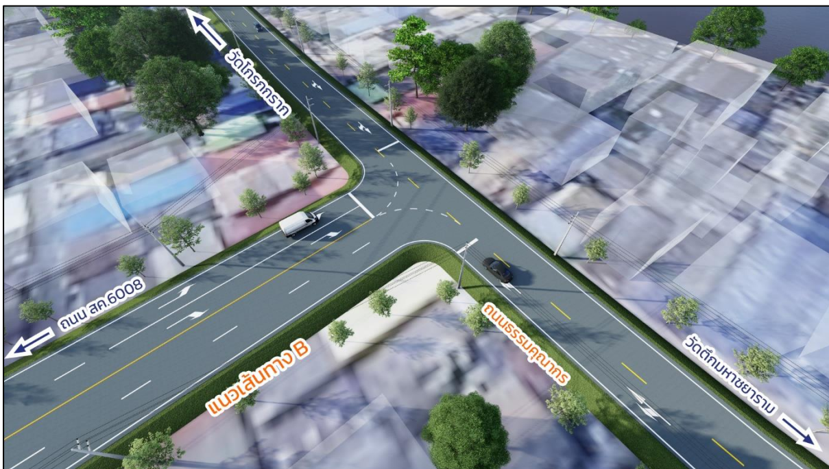
รูปที่ 17 รูปแบบทางแยกระหว่าง แนวเส้นทาง B กับ ถนนธรรมคุณากร
